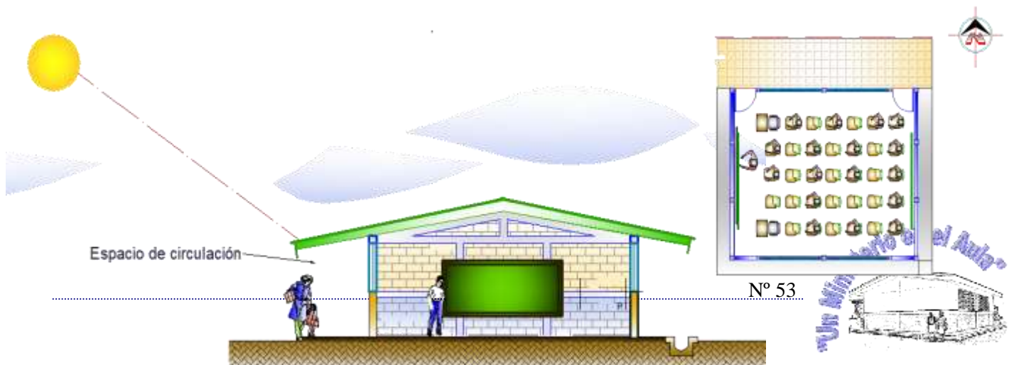
Figura N° 25 Protección solar del aula de clases
